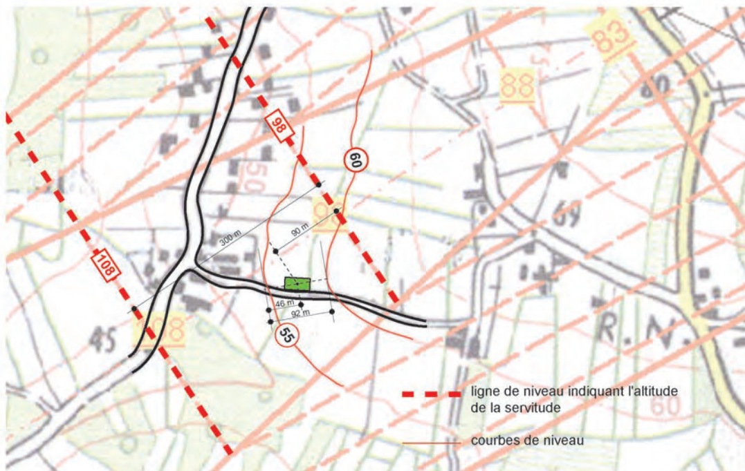
Figure 7 : Détermination de l'altitude de la surface de dégagement et de l'altitude moyenne du terrain
